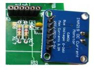
Das Modul wird mit einer Stiftleiste geliefert. Man kann aber auch die Stiftleiste nehmen die für das GLCD verwendet wurde.
