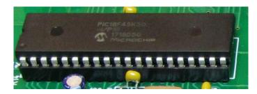
Es kann aber auch sein das sie einen Punkt in einer Ecke haben. Dreht man das IC nun so dass man die Aufschrift des ICs lesen kann, so befindet sich die Einkerbung oder der Punkt immer auf der linken Seite. Der erste Pin, der nun links unten ist, ist der 1. Pin. Nun werden die anderen Pins, gegen den Uhrzeigersinn durchnummeriert. Sollten noch Fragen zum Aufbau sein, so kann man jeder Zeit im Forum nachfragen.
