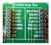
Mit dieser Schnittstelle kann das Board um verschiedene Hardware erweitert werden. Die Schnittstelle ist ein Standard der Firma Mikroelektronika. Sie bietet auch eine Menge an Module an, die mit der Schnittstelle laufen. Hier der Link zu den einzelnen Modulen. Es kann sein das die Software für die einzelnen Module, angepasst werden muss. Hier der Schaltplan.
