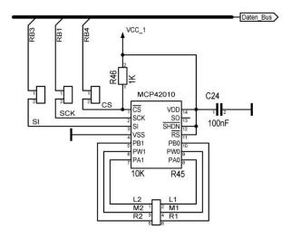
Hier mal eine Schaltung mit dem Poti. Hier kann man die Spannung regeln.
