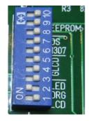
Eingeschaltet wird er über den Dip-Schalter 2. Ausgewertet wird der Drehgeber über den Port B5 und B6. Der Taster ist an Port B7. Hier der Schaltplan.
