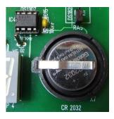
Der <u>DS 1307</u> ist eine Echtzeituhr. Das heißt dass das IC Uhrzeit und Datum ausgeben kann. Mit Hilfe der Batterie, bleiben auch bei Stromausfall, Datum und Uhrzeit erhalten. Da der DS 1307 nur sehr wenig Strom verbraucht, hält die Batterie über mehrere Jahre lang. Ausgelesen und programmiert wird der DS1307 über I2C Bus.
