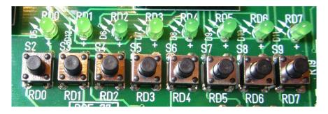
Das Board besitzt insgesamt 8 Leds und 8 Taster. Diese können einzeln angesteuert werden. Die Taster und Leds sind am Port RD0 bis RD7 angeschlossen.
